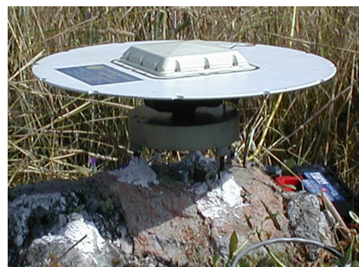
Foto 13 - Autocentrimento su affioramento roccioso. Il supporto dell'antenna è una base Max
