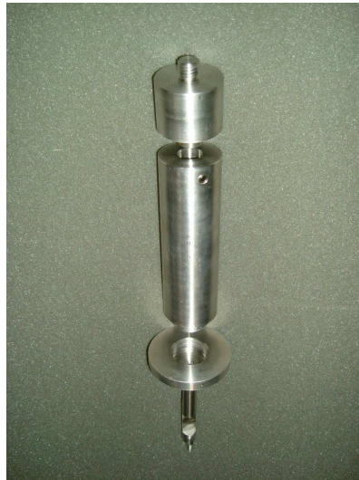
Foto 15 – Il sistema completo vertice – supporto antenna per stazioni permanenti
