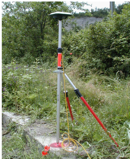
Foto 9 – Asta con bipiede posizionata su un chiodo geodetico L'antenna geodetica è avvitata sull'asta
