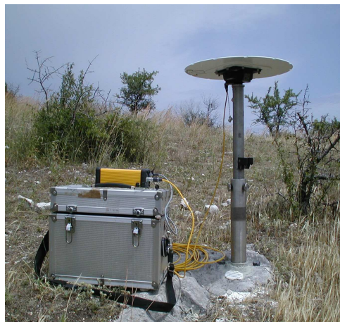
Foto 14 – Classica installazione su affioramento. Ancorato alla roccia c'è il caposaldo 3D e sopra il sistema di supporto dell'antenna geodetica, a sua volta allacciata al ricevitore satellitare
