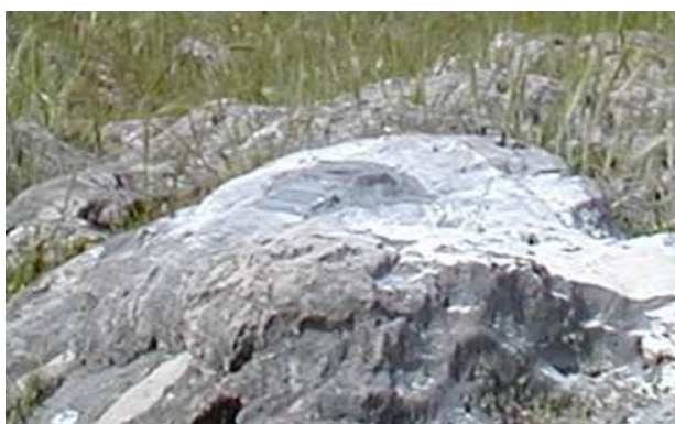
Foto 3 – Affioramento roccioso: al centro si può intravedere un caposaldo (foto 8) cementato in modo che sia la sola superficie ad essere visibile
